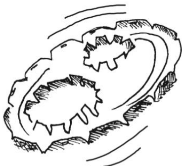
Крышка с вырезанными и отогнутыми лепестками.
