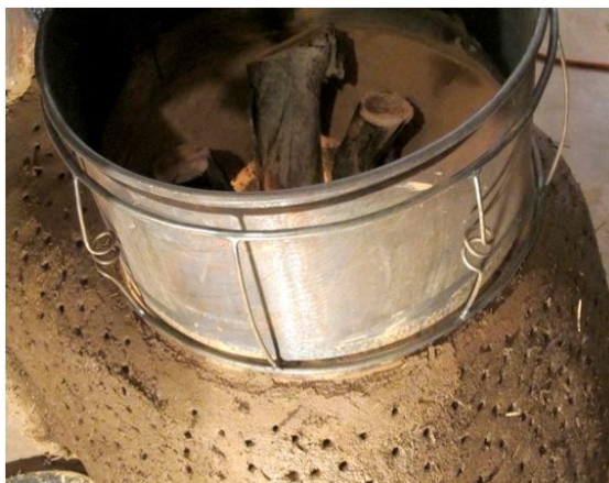
Сваренный орнамент из проволоки вокруг бочки напоминает о том, что она горячая
