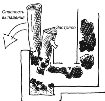
Опасность выпадения прогоревшего полена. Загружайте толстым концом вниз.
