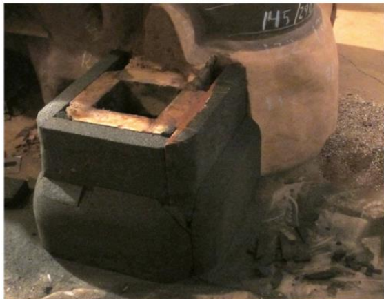
Изоляция пеностеклом – моим любимым материалом с недавних пор – вокруг топки повышает температуру сгорания и защищает горячую зону, нагревающуюся до 150 градусов.
