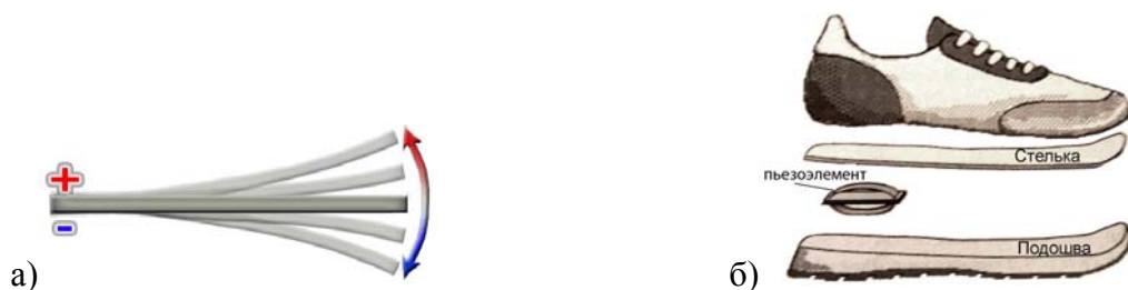
Рис. 9. а - Механические колебания кантилевера из пьезоэлектрического материала преобразуются в электрическую энергию; б - пьезоэлектрический элемент для сбора энергии при ходьбе
